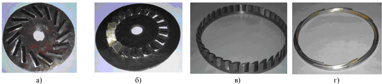
Рис. 2. Фотографии тарелок: а, б – с осевым многолопастным завихрителем; в, г – с тангенциальным завихрителем
