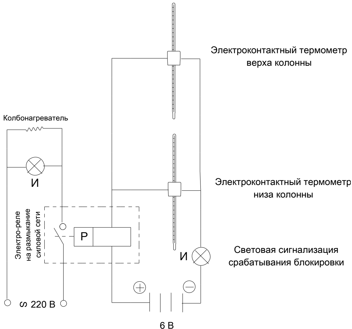
Рис. 6 Принципиальная электрическая схема нижнего уровня АСУ ТП ректификации
