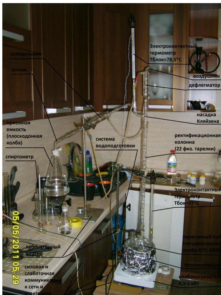
Рис. 5 Лабораторная ректификационная установка
