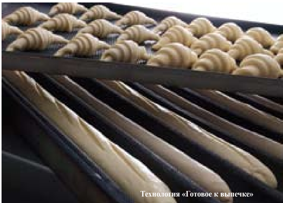
Рис.5 Технология замороженных полуфабрикатов без расстойки, готовых к выпечке «PAF»
