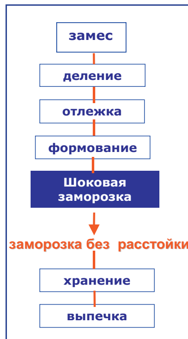
Рис.5 Технология замороженных полуфабрикатов без расстойки, готовых к выпечке «PAF»
