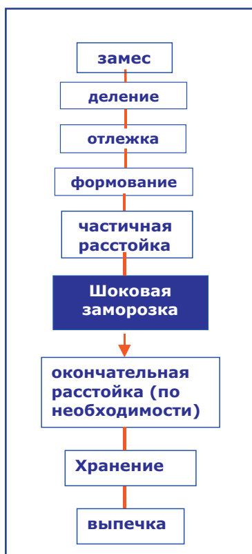
Рис. 6 Технология частично расстойных замороженных полуфабрикатов
