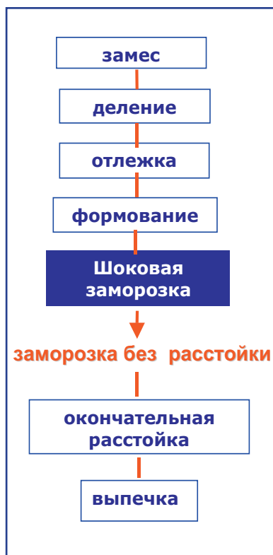
Рис.4 Технология замороженных тестовых полуфабрикатов, требующих окончательной расстойки.
