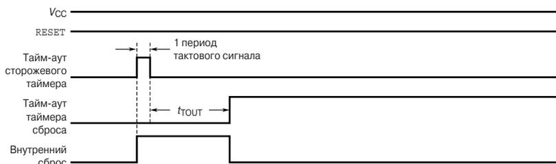
Рис. 2.52. Временные диаграммы сигналов при сбросе от сторожевого таймера
