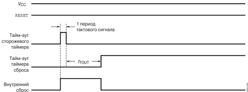
Рис. 1.32. Временные диаграммы сигналов при сбросе от сторожевого таймера
