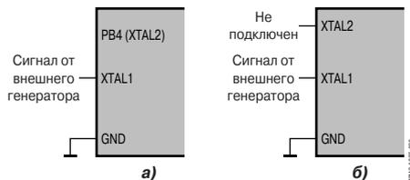
Рис. 1.27. Подключение внешнего источника тактового сигнала:
