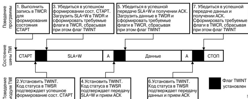
Рис. 2.122. Пример взаимодействия программы с модулем TWI
