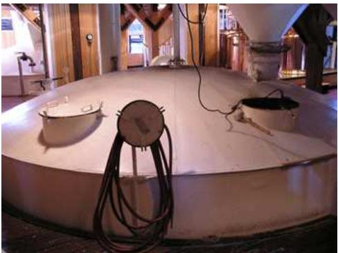
Рис. 3.16. Внешний вид аппарата для затирания сусла
