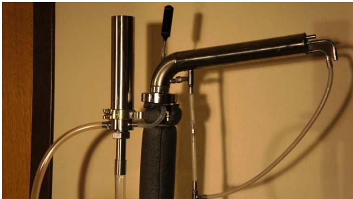
При отсутствии дорогостоящего дозирующего насоса для подачи браги в НБК используется система дозированной подачи браги методом ее подачи в систему «сообщающихся сосудов». Насос из емкости с брагой подает ее в устройство перелива (на фотографии) с механическим регулятором уровня подачи браги в колонну. Одновременно
