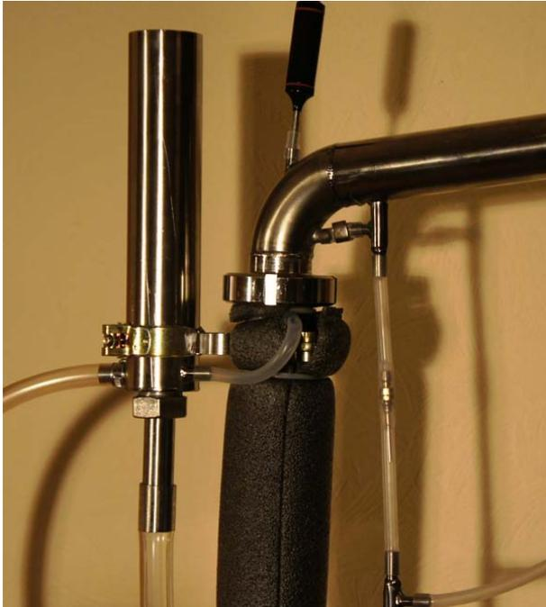
Еще раз посмотри на устройство перелива. Насос, находящийся на дне бродильной емкости, подает брагу в узел (трубка слева)
