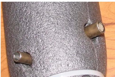
Вот фотография низа колонны. Верхний штуцер (большого диаметра, справа) предназначен для слива барды, нижний (меньший) для термометра. Хотя я лично предпочитаю наоборот – термометр устанавливать выше, в зону пара, а не жидкости. Связано это с тем, что при малой подаче жидкости внизу возникает некая «застойная зона» слабой конвекции, и индицируемая температура может
