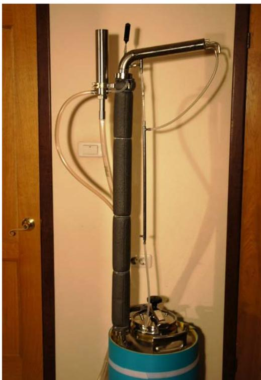
На фотографии колонна НБК установлена на куб, который в данном случае используется в качестве парогенератора. На колонну установлен узел подачи браги, необходимый для дозирования потока браги из бродильной емкости в верх колонны. На верх колонны установлен штатный дефлегматор ХД/З, где пары СС конденсируются и сливаются в приемник.
