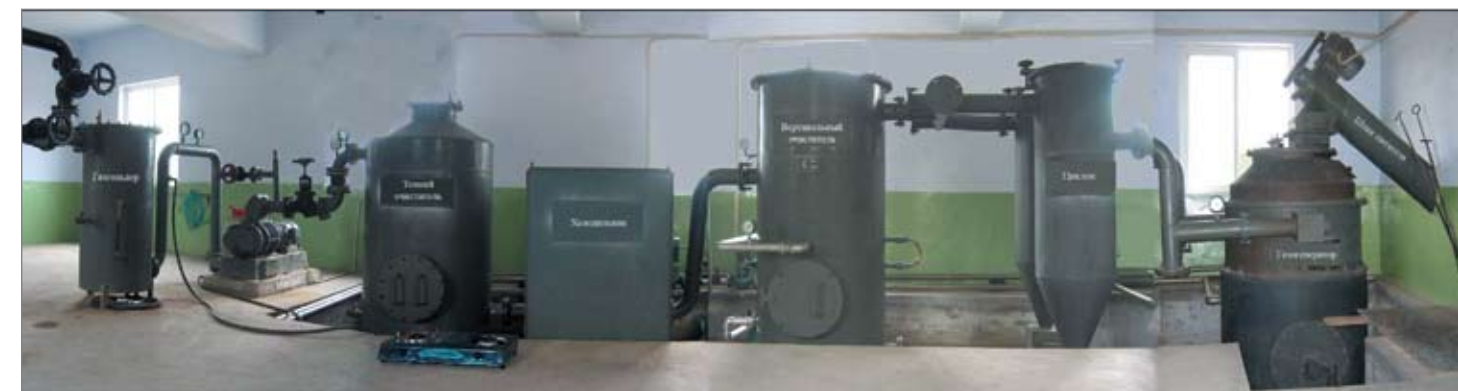
Рис. 11. Газогенераторная установка мощностью 300 кВт, работающая на сельскохозяйственных растительных отходах влажностью до 40%
