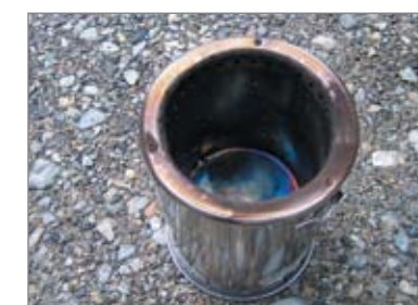
Рис. 15. Переносная газогенераторная установка тепловой мощностью 2,4 кВт, работающая на растительных и древесных отходах биомассы влажностью до 40% и предназначенная для приготовления пищи в походных условиях
