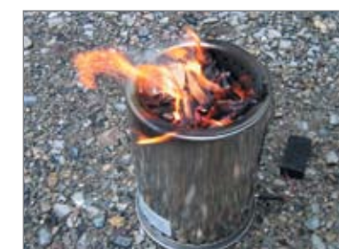
Рис. 15. Переносная газогенераторная установка тепловой мощностью 2,4 кВт, работающая на растительных и древесных отходах биомассы влажностью до 40% и предназначенная для приготовления пищи в походных условиях
