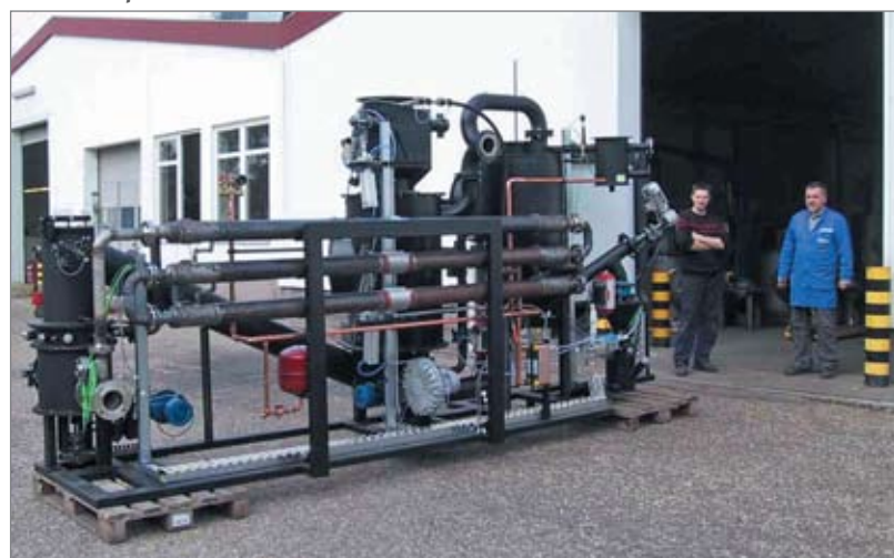
Рис. 6. Газогенераторная установка силовой мощностью 100 кВт (производство – немецкая фирма Spanner RE GmbH), работающая на отходах древесной биомассы влажностью до 30%
