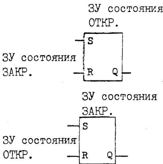
Состояние «0» будет на выходе также и в том случае, если задвижка находится в соответствующем крайнем положении. Это крайнее положение регистрируется датчиком, также связанным с входом сброса.
