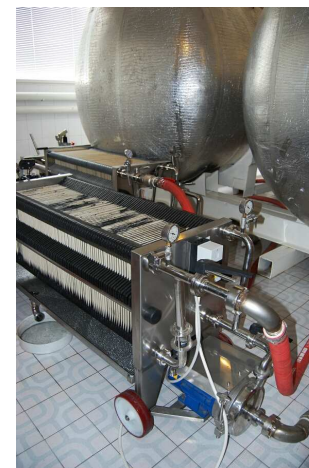
Рис. 8.4. Фильтрующий каскад установки «Полтавчанка»
