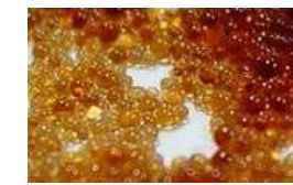
Lewatit MonoPlus (S 100 и S 100 H) – ионообменные смолы, относящиеся к группе сильнокислотных гелеобразных катионитов.
