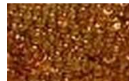
ГРАНИОН 001x8 Na – сильнокислотный гелевый катионит на основе сульфированного сополимера стирола и дивинилбензола. Обладает высокой химической стойкостью к щелочам, кислотам и окислителям, высокой механической прочностью и термической стойкостью.
