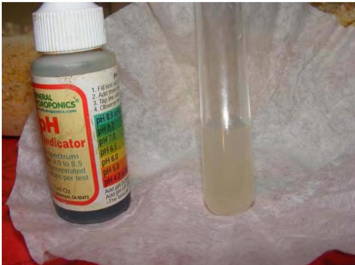
17. После добавления трёх капель индикатора pH, цвет показывает уровень ниже 4.0, как и ожидалось. Теперь содержимое можно использовать как закваску, источник кислоты для замачивания или даже затирания.
