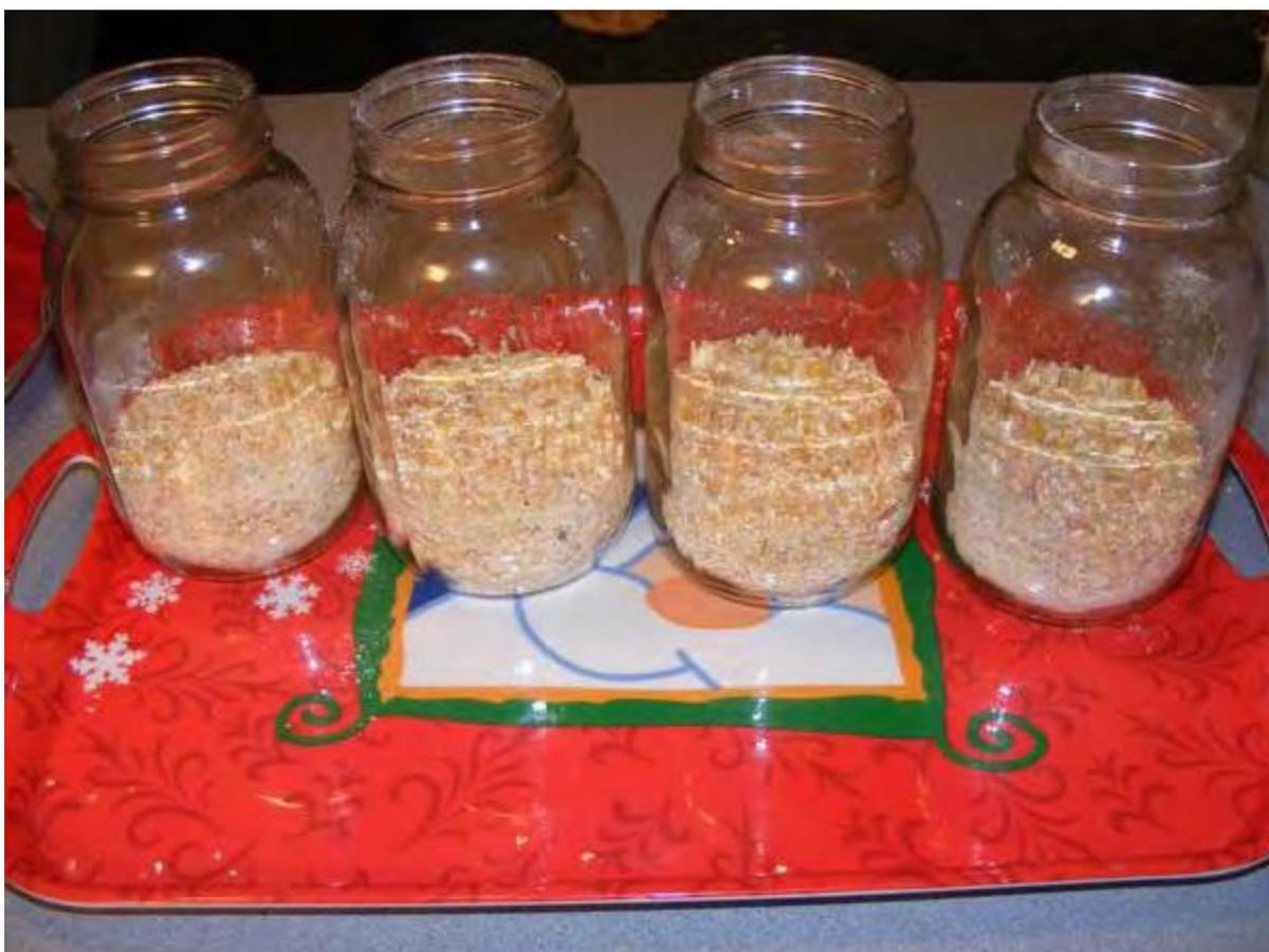
2. Добавляю дождевую воду. Хорошо размешиваю, самые лёгкие частицы сначала плавают на поверхности воды.
