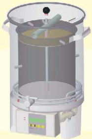
Пивоваренный котел заполненный солодом
