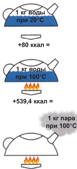
Рис. 6-1 На этих рис. показано, сколько тепла требуется, чтобы произвести один кг пара при атмосферном давлении. Обратите внимание, что для повышения температуры до точки кипения требуется 1 ккал на каждый 1°C, но для превращения воды при 100°C в пар с температурой 100°C требуется значительно большее количество ккал.
