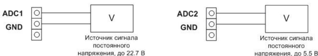
Каждый из каналов имеет свою допустимую границу входного сигнала по напряжению. Первый канал (клемма ADC1) имеет расширенный диапазон входного сигнала от 0 до 22.7 В. Второй канал (клемма ADC2) – не более 5.5 В.
