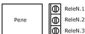
По умолчанию, в исходном состоянии после подачи питания на модуль контакты каждого из реле ReleN.1 и ReleN.2 замкнуты (управляющее напряжение на реле отсутствует). Путем подачи КЕ команды \$KE,REL или через Web-интерфейс управления можно переключить состояние реле. Таблица ниже показывает соответствие между положениями контактов реле и поданных КЕ-команд.
