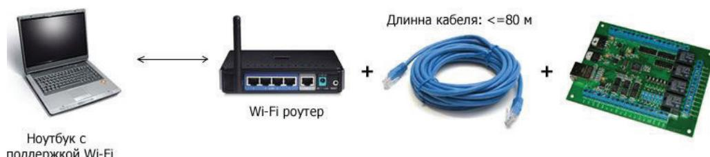
*Схема беспроводного подключения компьютер – модуль с использованием WiFi роутера*
