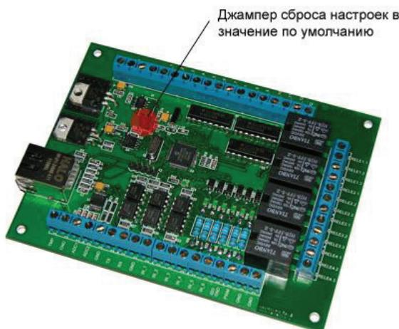
Алгоритм действий для сброса аппаратных настроек с помощью джампера сброса:
