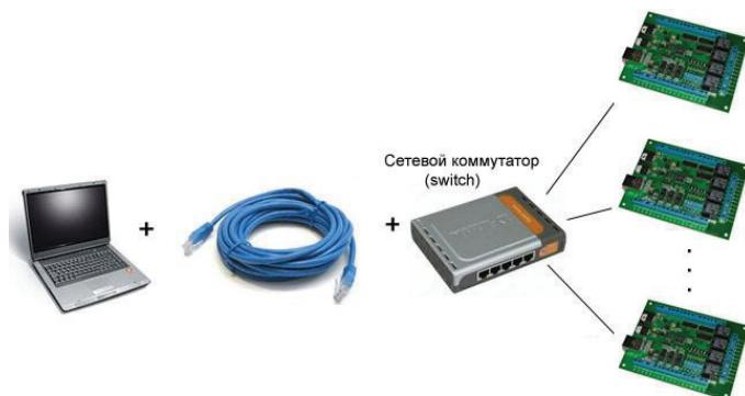
*Схема подключения нескольких модулей к одной сети с использованием роутера*
