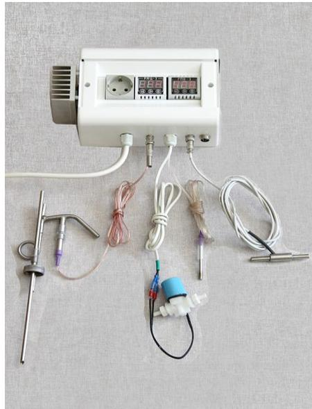
Фото 2. Внешний вид блока с датчиками и клапаном отбора
