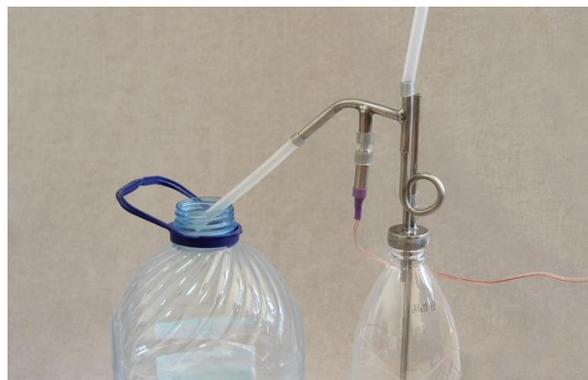
Фото 17 Датчик наполнения емкости в узле автоперевода отбора
