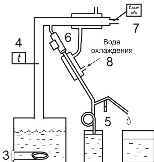
Рис. 4. Схема сборки оборудования для ректификации
