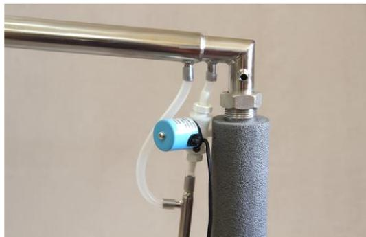
Фото 31 Установка клапана отбора
