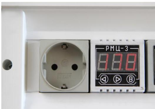
Фото 3 Модуль РМЦ и розетка подключения ТЭНов
