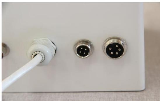
Фото 11 Гнезда для подключения датчиков
