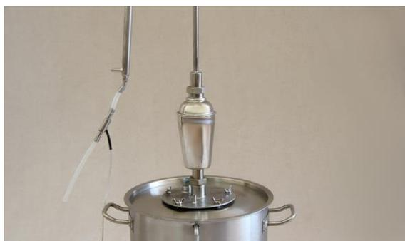
Фото 14 Датчик в режиме дистилляции
