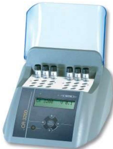
Анализатор CR 2200 для определения ХПК, общего азота или фосфора
