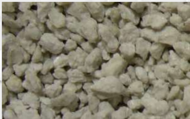
Фильтрующая среда FILTER - AG (компания Clack Corporation, США) - обезвоженный алюмосиликат
