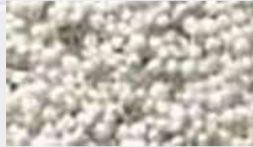
ГРАНИОН D 001 Na – сильнокислотный макропористый катионит на основе сульфированного сополимера стирола и дивинилбензола. Обладает высокой химической и термической стойкостью, высокой механической прочностью.
