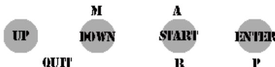
Базовым принципом этого конфигурационного меню является процесс “шаг затирания”. Для каждого шага пользователь может задать целевую температуру (SetPoint) – так же, как и длительность шага. Кроме того, всегда возможно пропустить некоторые из шагов в соответствии с графиком рецепта через кнопку START.
