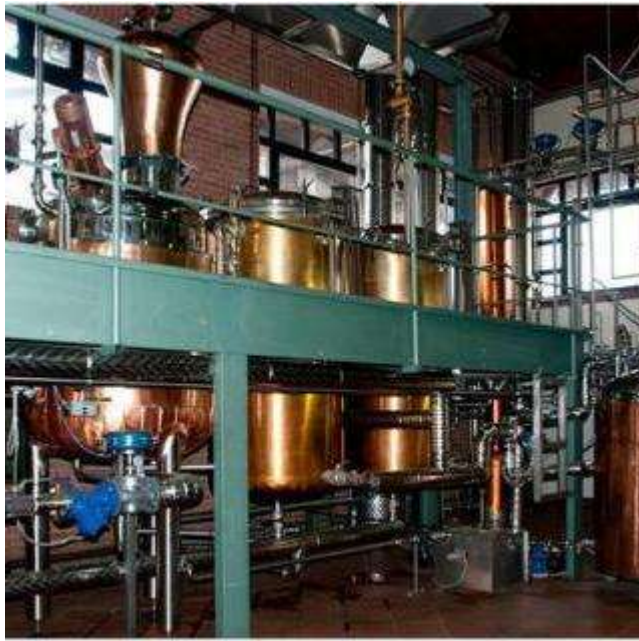
Рисунок 8 – Дистилляторы непрерывного цикла
