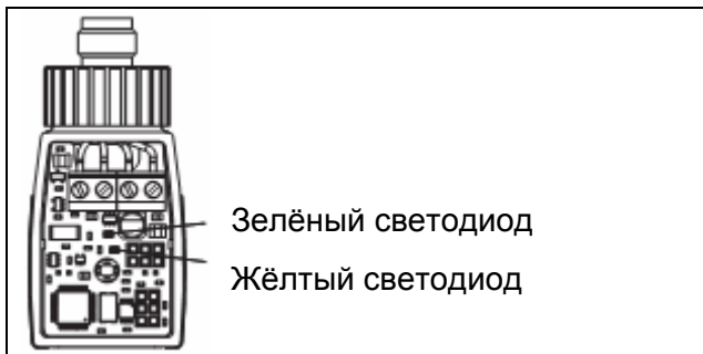
Рис. 6-2: Светодиоды на исполнении без функционального блока
