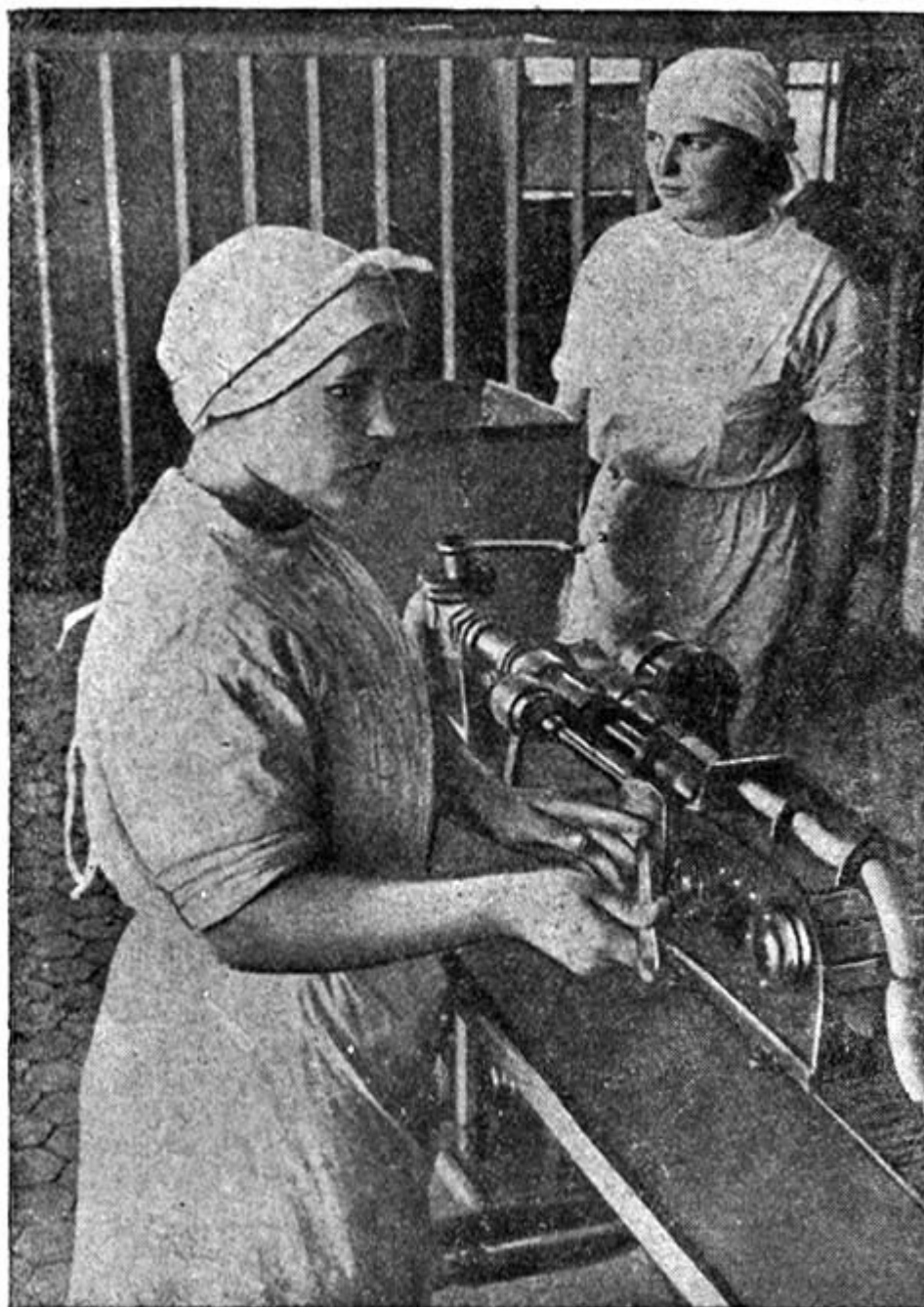
Рис. 10. Делительный аппарат для откручивания сосисок
