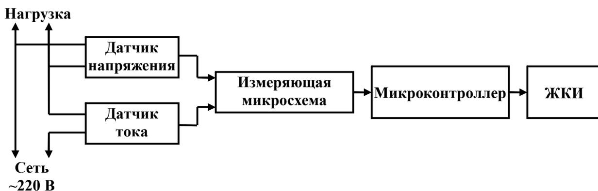
Рис.1. Структурная схема однофазного измерителя коэффициента мощности
