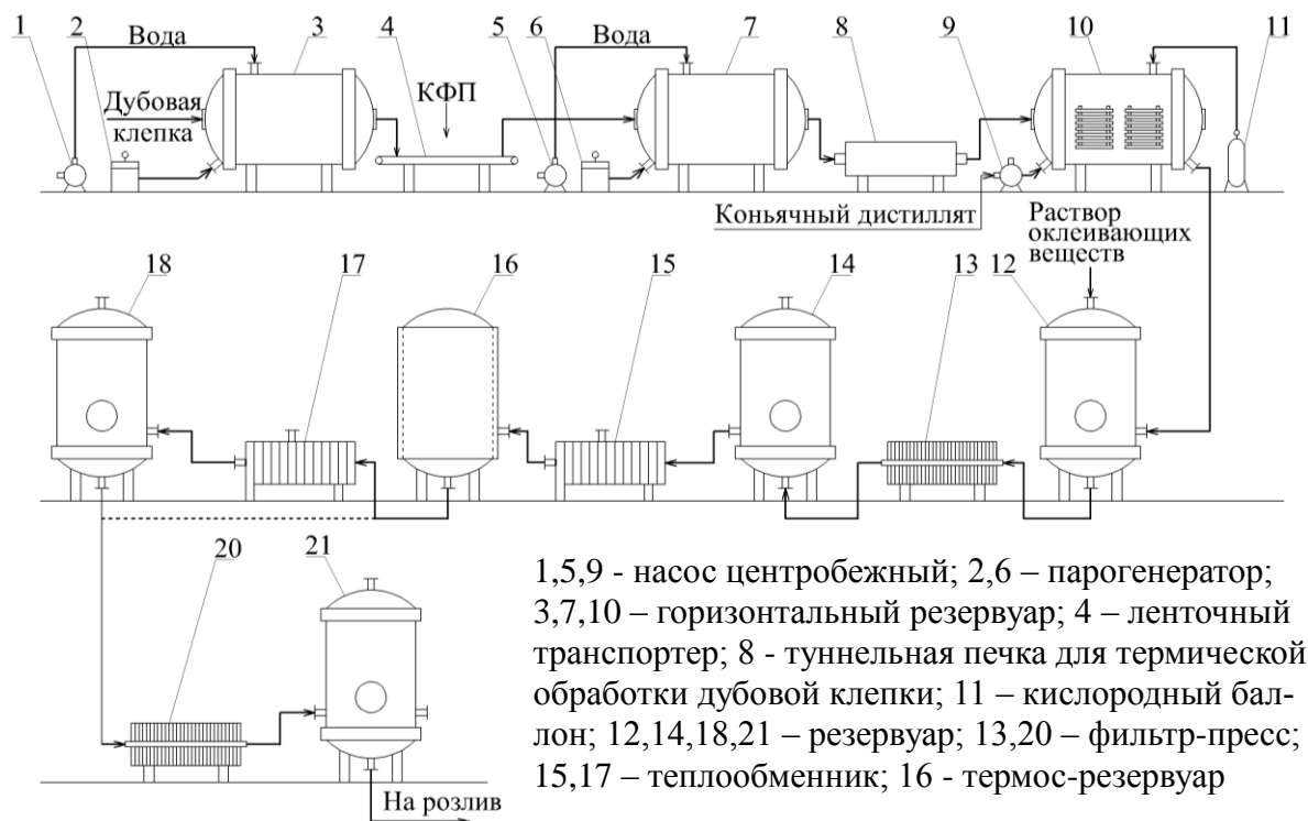
Рисунок 21 – Аппаратурно-технологическая схема производства трехлетнего российского коньяка с использованием активированной дубовой клепки
