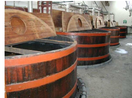
Рис. 3.20. Внешний вид бродильных чанов
