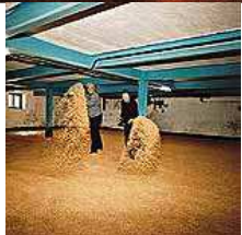
Рис. 3.10. Ручное ворошение прорастающего зерна
