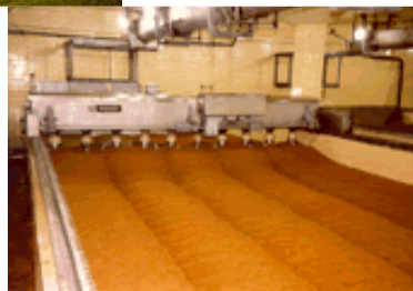
Рис. 3.12. Современные установки Саладин с ворошителями
