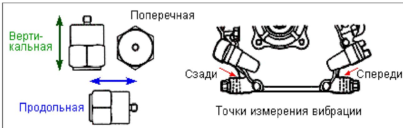
В точке измерения необходимо удалить грязь и масло с поверхности двигателя и прикрепить датчик быстросхватывающим клеем. Такой способ обеспечивает прочность крепления и надежность измерений во всем частотном диапазоне.
