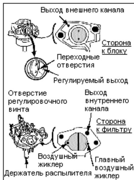
2. Вращением ограничительного винта дроссельной заслонки карбюратора установите указанную в таблице частоту вращения двигателя в режиме холостого хода:
