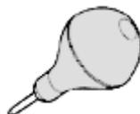
**Отвертка с плоским жалом (диаметр 6 мм)**
