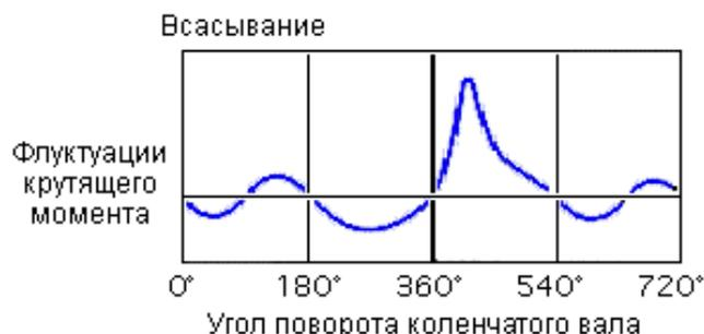
Характер флуктуаций крутящего момента в одноцилиндровом четырехтактном двигателе иллюстрирует приводимый график.
