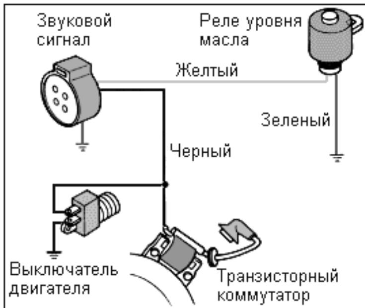
На двигателях GXV270/340/390 (с вертикальным коленчатым валом) применена усовершенствованная система контроля уровня масла. В ней при разомкнутом (рабочем) положении выключателя двигателя замыкание контактов язычкового реле датчика уровня масла приводит к замыканию первичной обмотки катушки зажигания на землю через звуковой сигнал, в результате чего двигатель останавливается.
