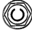
Многие болты, применяемые в силовой продукции корпорации Honda, относятся к самонарезающему типу. Такие болты легко опознать по нанесенной на головке болта букве "С".
