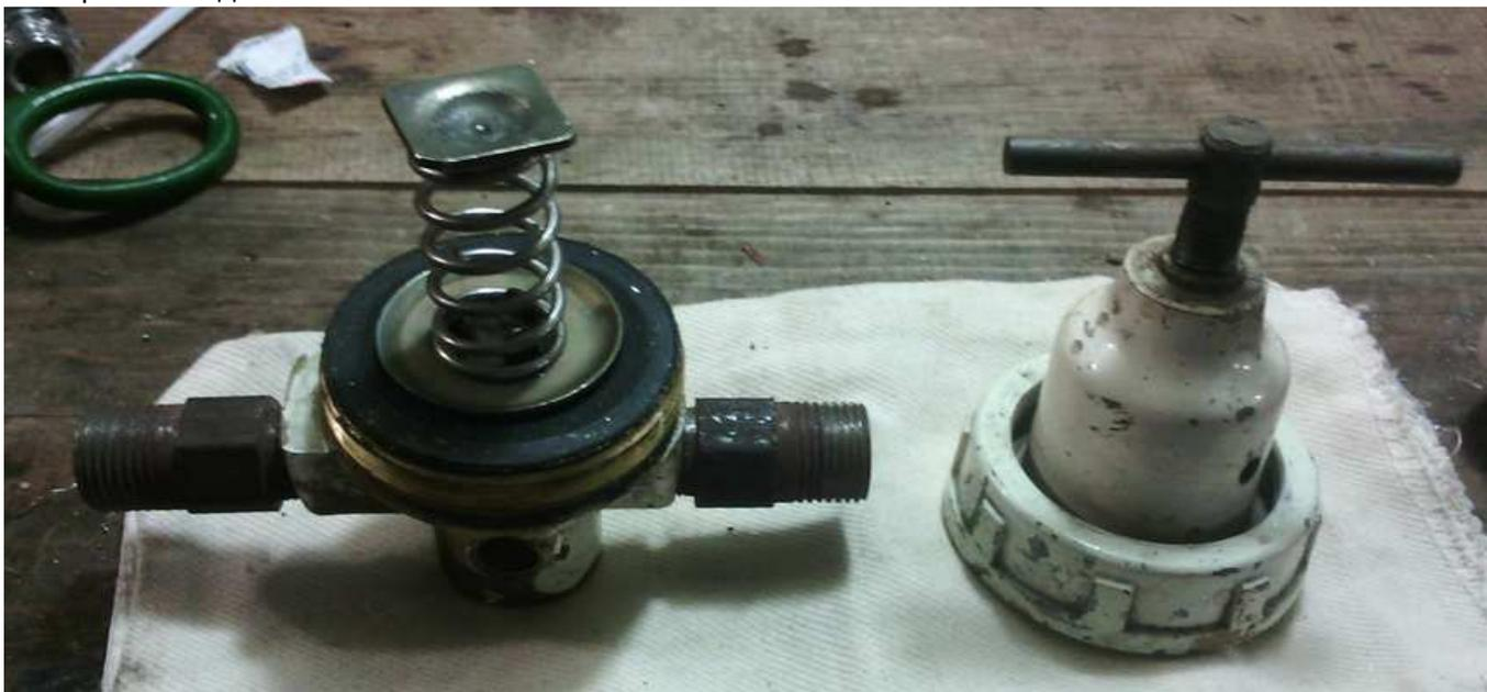
Неполная разборка.. При очень-очень ржавой воде, что бы промыть, достаточно надавить на пуговку штока клапана.. (разобшительный кран – конечно надо прикрыть чутка). Тогда все микрочастицы – моментально вымываются из под запорного клапана.. Ход штока кланана – 3 мм, сечение хорошее..
