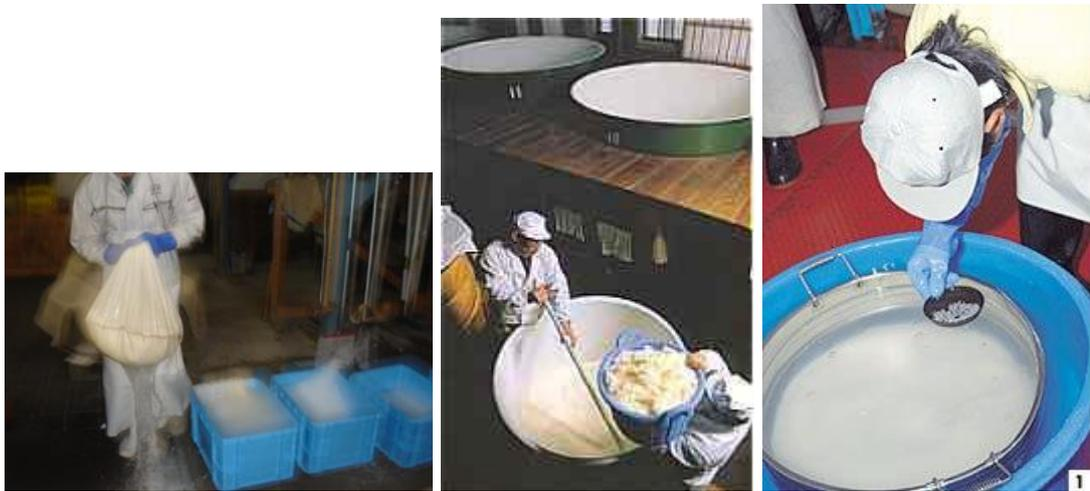
Рис. 5.8. Промытый рис замачивают на несколько часов до достижения влажности оптимальной для дальнейшего разваривания.
