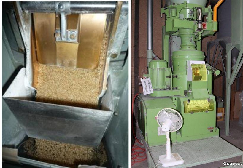
Рис. 5.4. Зерна риса сначала проходят через полировочную машину, чтобы удалить оболочки крахмальных гранул. Степень шлифовки зависит от категории напитка.
