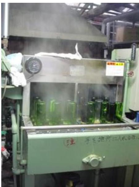
Рис. 5.33. Напиток, разлитый в бутылки погружается в подогретую воду для пастеризации по меньшей мере два раза.
