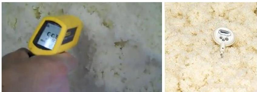
Рис. 5.17. Дистанционный контроль температуры выращивания
