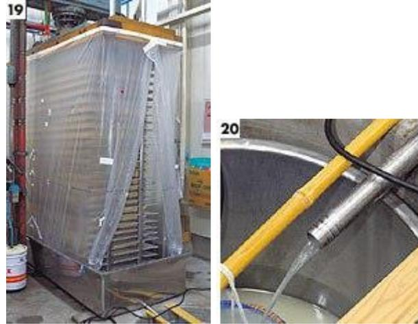
Рис. 5.30. Отжатие сусла через тканевые пакеты гидравлическим прессом
