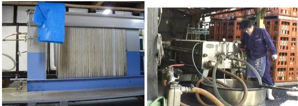
Рис. 5.31. Фильтрация на фильтр-прессе.
