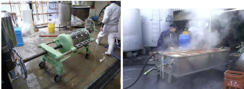
Рис. 5.32. Пропущенная через фильтр-пресс жидкость для удаления нежелательных соединений фильтруется через угольный фильтр.
