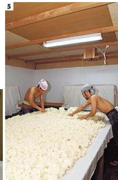
Рис. 5.13. Размещение разваренного рис на кюветах и растильных столах
