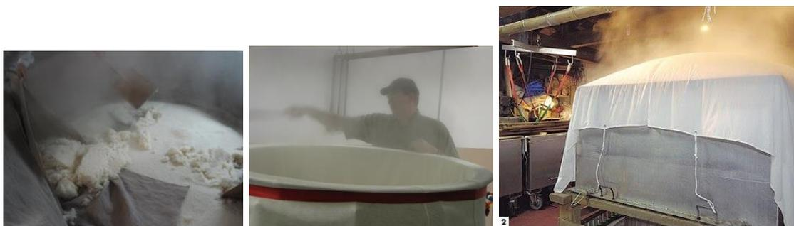
Рис. 5.10. Разваривание необходимо для растворения крахмала в воде, а также стерилизации зерна перед его использованием.
