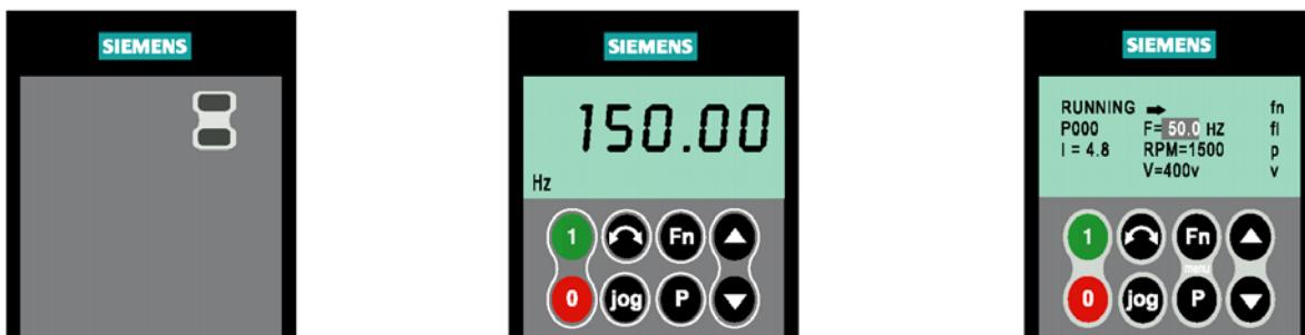
Рис. 3-1 Лицевые панели, поставляемые для преобразователей MICROMASTER 420
