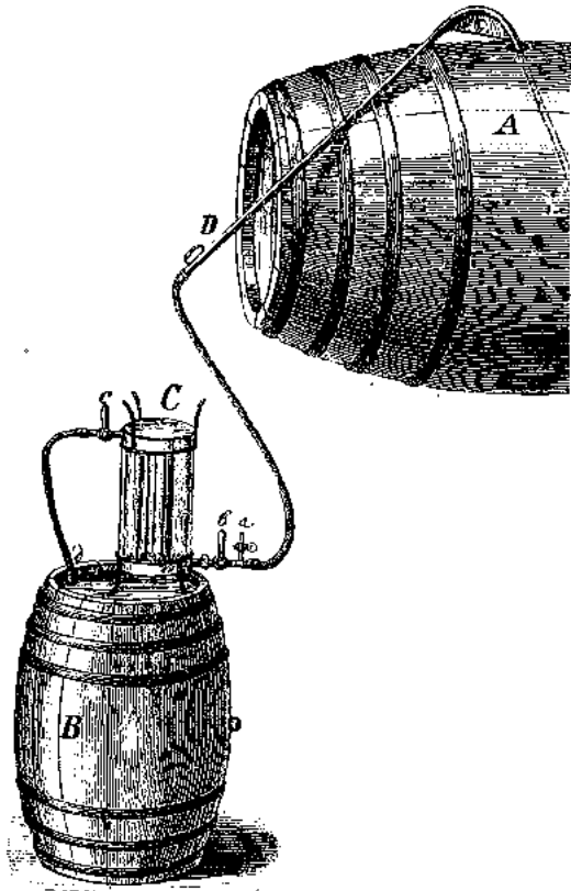
Фиг. 59. Вольмара патентованный сифонный фильтр.
