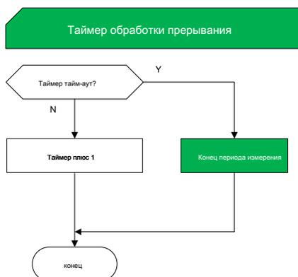
карта 10 Таймер обработки прерывания
