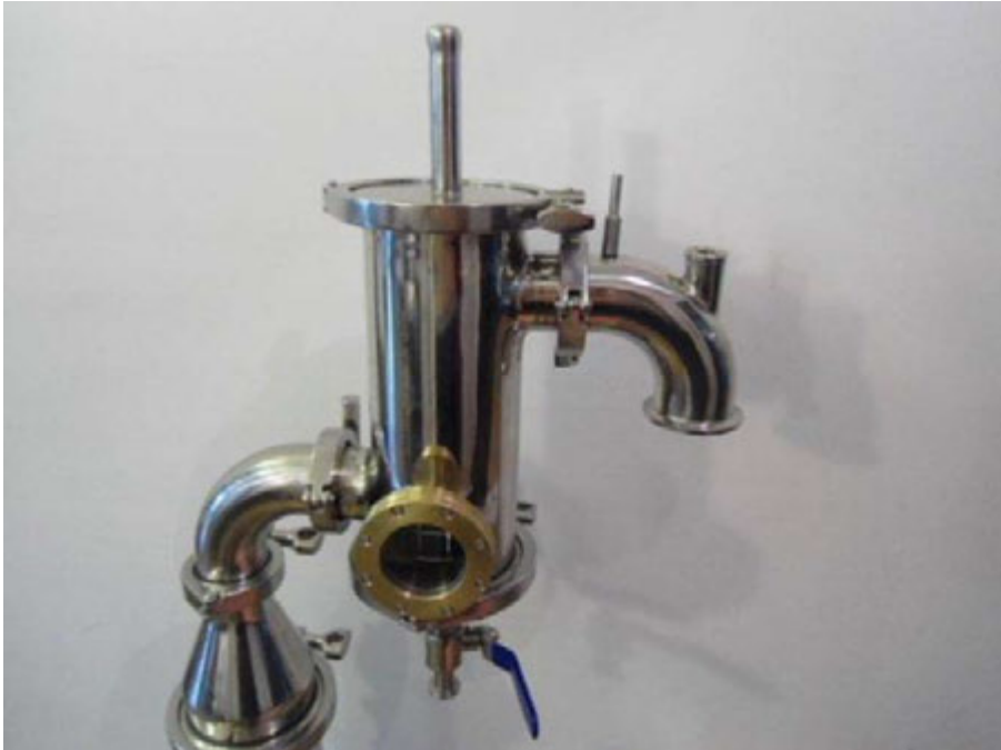
Рис. 11. Собранная джин-корзина с дополнительным очистительным каналом с изгибом 90°.
