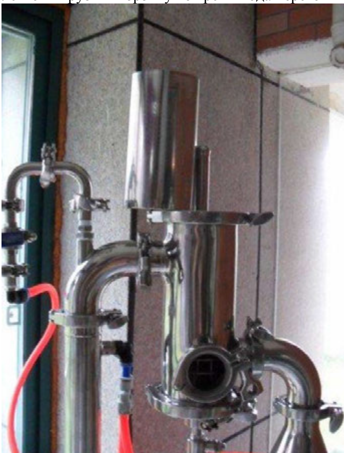
Рис. 12. Стандартная конструкция с очистительным каналом с изгибом 90°.
