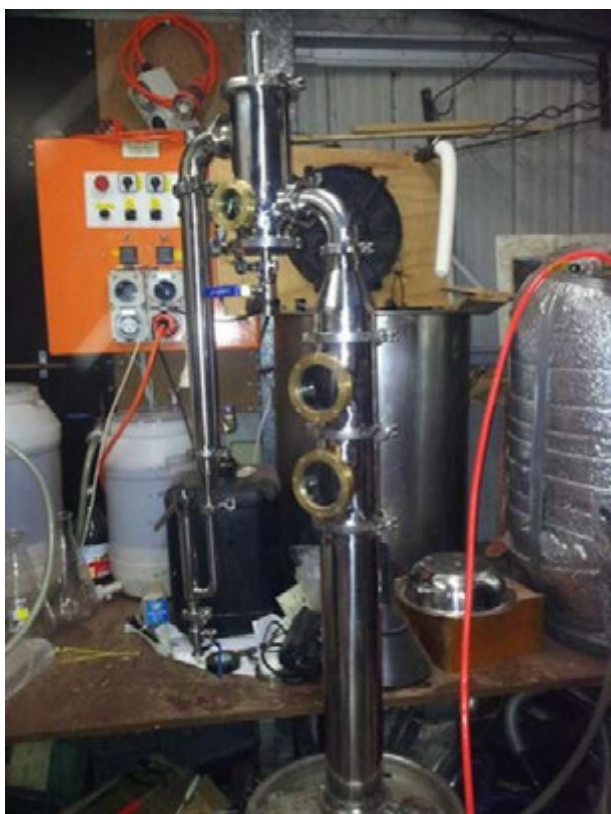
Рис. 10. Джин-корзина, отрегулированная по высоте с использованием секции 510 мм и двух тройников без тарелок.
