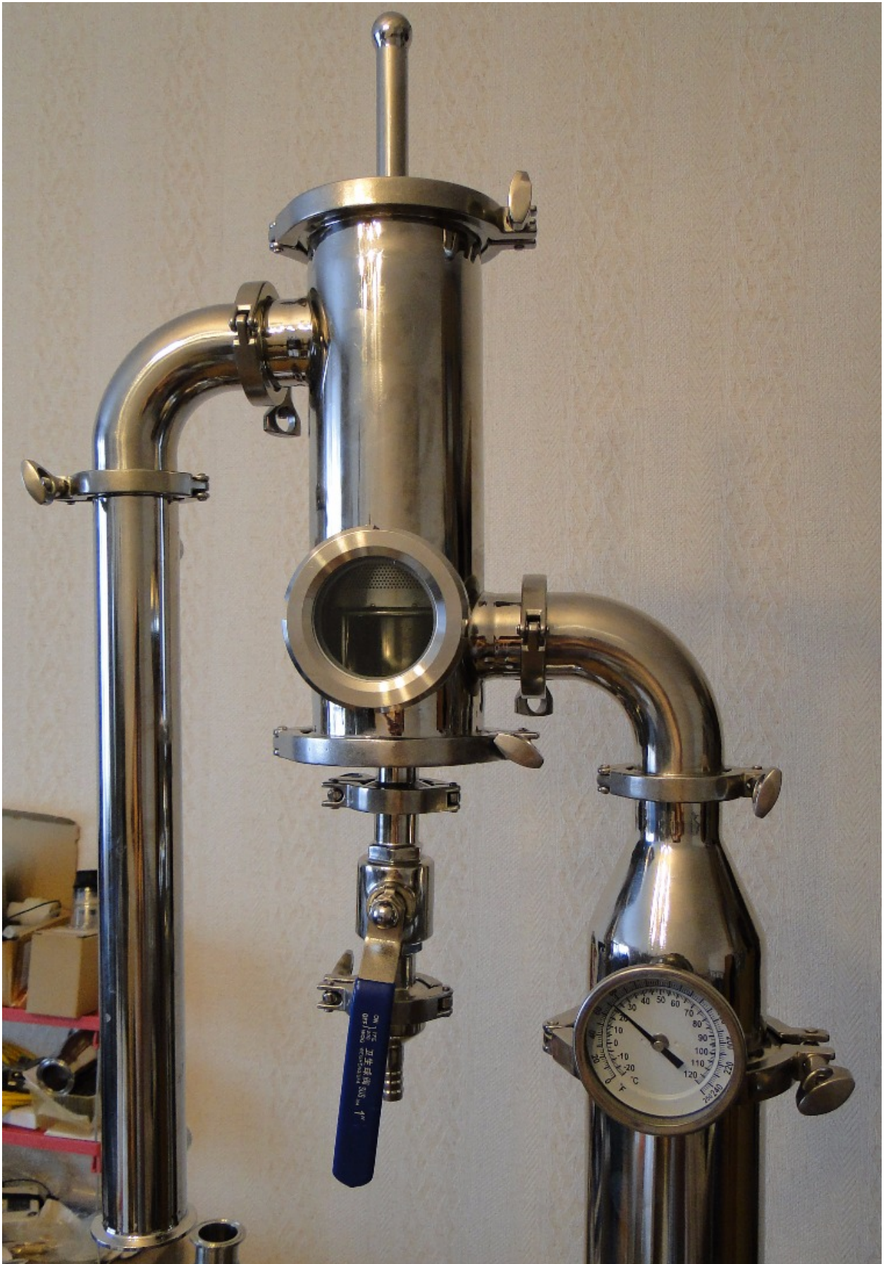
Рис.9. Монтаж джин-корзины на 4-х дюймовую установку.
