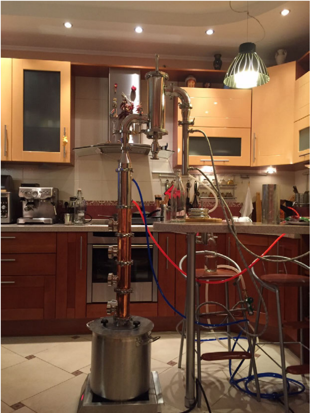
Рис.8. Монтаж джин-корзины на 2-х дюймовую установку.
