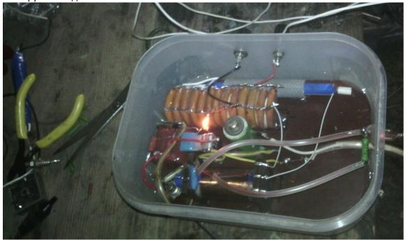
Всю эту хрень - размещаем в пищевом контейнере.. На трансформаторе намотана дополнительная обмотка 300 витков - для питания неоновой лампочки (справа)..
