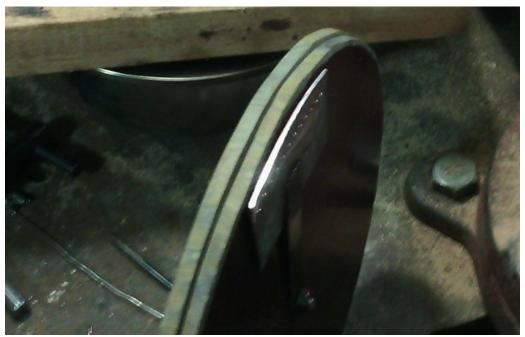
Сверлить нужно - сразу два диска.. сделайте синхронизирующую метку - пропилив ножовкой по металлу небольшой запил, на глубину 2 мм. Потом эти риски надо совместить..
