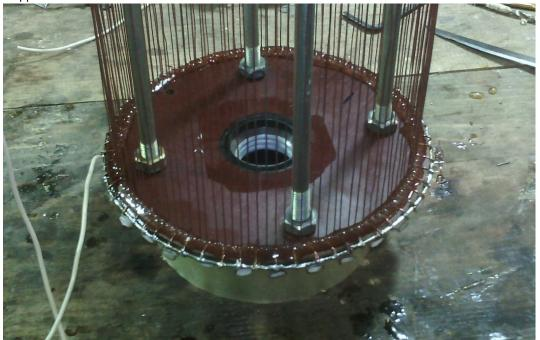
После сборки - все отверстия и пространство - заливаем клеем из термопистолета. Этот полимер - очень хороший диэлектрик. заливка клеем - позволит избежать засорения отверстий всяким мелким мусором от мух, и создания утечек тока. Клеем - проходим с обеих сторон каждого диска..
