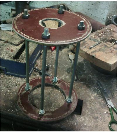
Шпильки М8 - длиной 25 см. Нижнее отверстие диаметров 80 мм (что бы лампочку вкручивать). Еще для того - что бы после сборки - поджимая гайки, натянуть все струны проводов в натяг. Верхнее отверстие - для электропатрона лампочки.. (фото в низу - процесс приклеивания патрона эпоксидкой).
