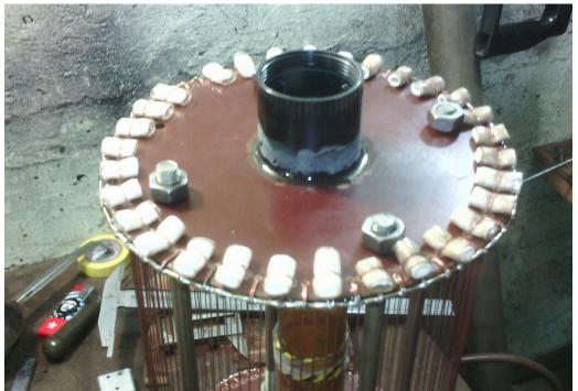
Изоляторы - трубка хлорвиниловая, внутри дополнительно - силиконовая белая трубка. Служит поджимным депфером - когда, после сборки - будет разжимать диски, для равномерной натяжки проводов.
