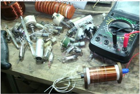
Дежурный хлам - времен СССР. на заднем плане - керамические конденсаторы 6,3 кВ - 2200 пикофарад.. 13 штук.. получилась суммарная емкость 0,022 мкФ. разряд такой сборки конденсаторов - напоминает щелчок стального шарика от воздушки - если кинуть его в оконное стекло...
