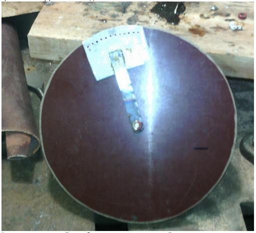
Очень важно - сделайте шаблон.. кусов 1 мм луженой меди, огрызок полотна по металлу - и очень тщательно размеренные метки для сверления. После сверления - сдвигаем, в крайнее отверстие шаблона - вставляем спицу.. синхронизируя крайние отверстия.. сверлил обычной скоростной дрелью (250 ватт). Диск зажимал в тиски.
