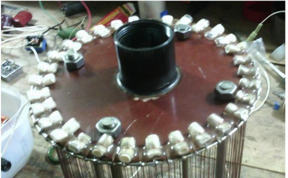
Все готово.. Клеем пролито, диски разжаты - провода натянуты до равномерного упругого звона. Вертикальные провода - луженая медь диаметром 0,5 мм... По торцу диска - общая шина.. медный провод 1 мм по окружности диска..
