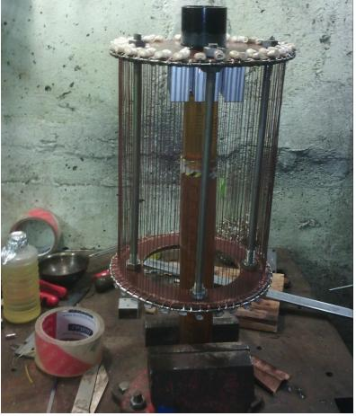
В малое отверстие подклеил скотч, поставил упор, подвесил - и в щель залил эпоксидку.
