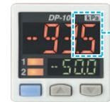
Отображение измерений в 0,1 кПа
