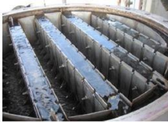
Рис.13 - Распределитель орошения желобчатого типа для колонн диаметром свыше 400 мм
