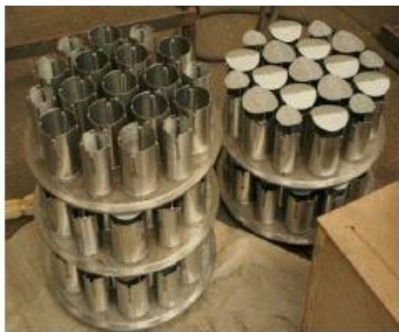
Рис.12 - Распределители орошения патрубкового типа для колонн диаметром до 400 мм
