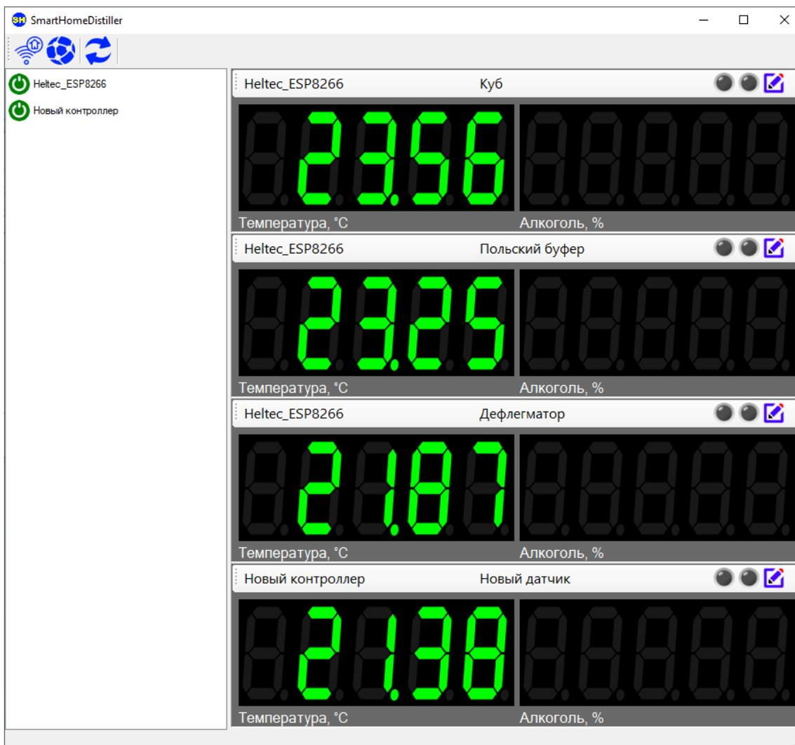
В режиме редактирования датчика можно включить отображения показаний содержания алкоголя в парах и выставить пороги сигнализации по температуре и содержанию алкоголя. Пороги выставляются на превышение верхнего порога и уменьшение показаний ниже нижнего порога.
