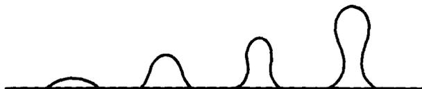
Рис. 10. Изменение формы пузырьков пара на горизонтальной поверхности при увеличении их объема.
