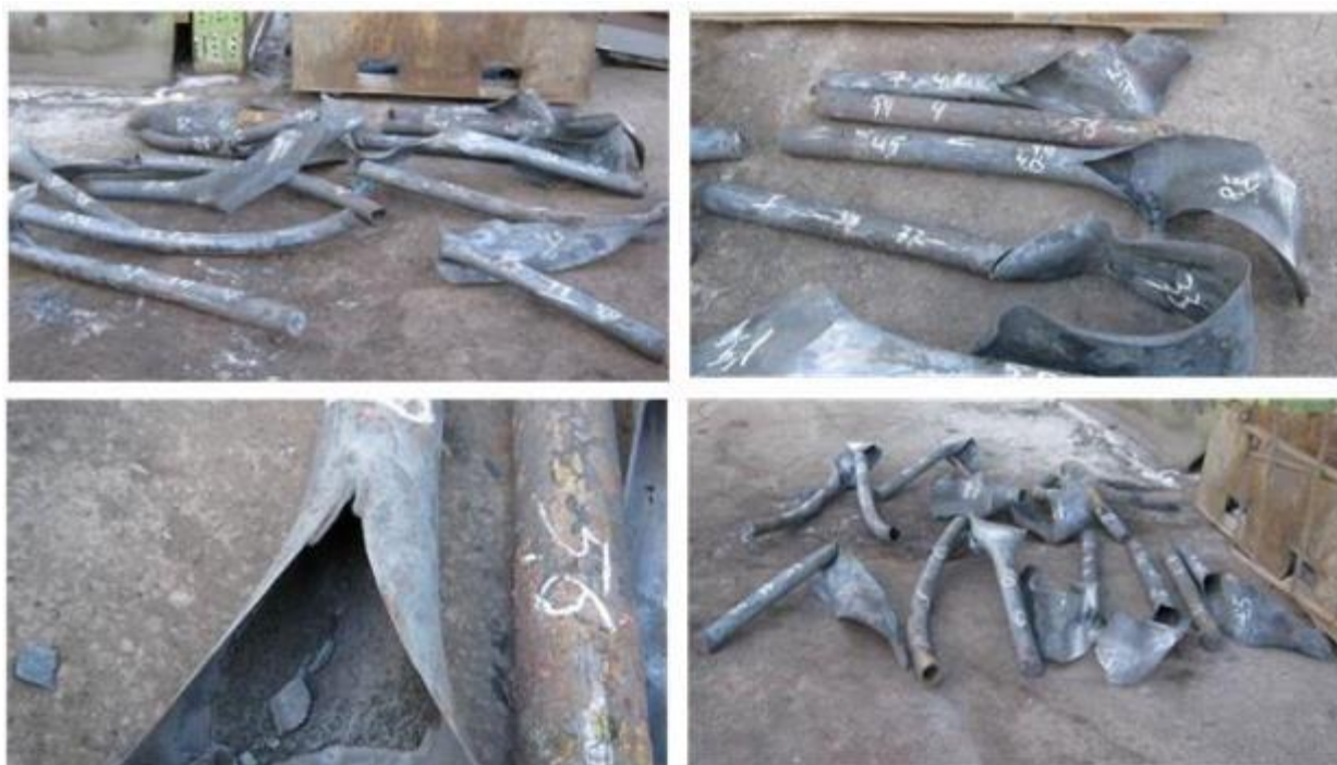
Рисунок 2.5 – Общий вид термосифонов, вышедших из строя в результате инцидентов
