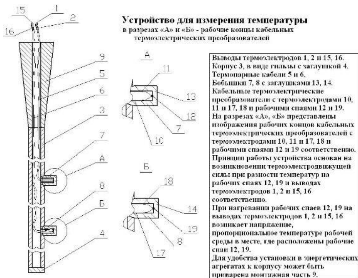
Рисунок 2.12 – Устройство для измерения температуры по высоте полости термосифона
