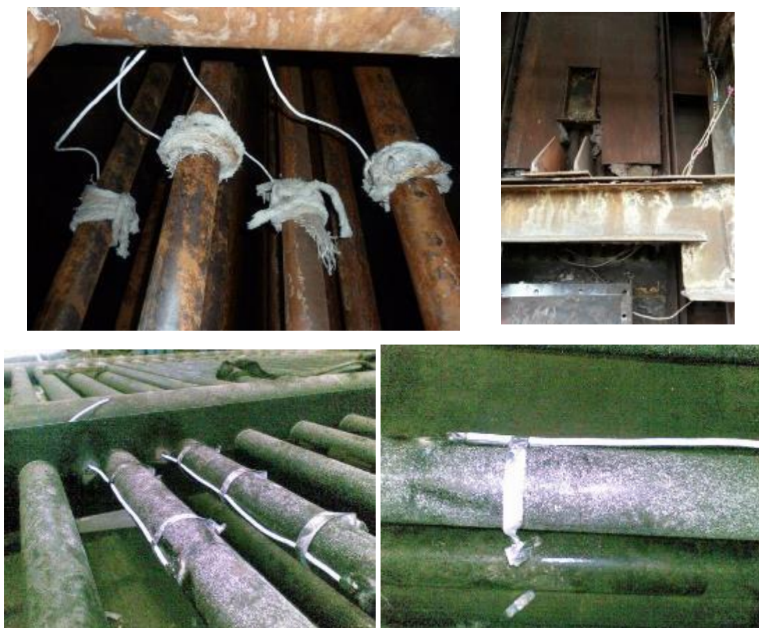
Рисунок 2.10 – Изображение «зачеканенной» термопары в стенку трубы испарительной зоны термосифона
