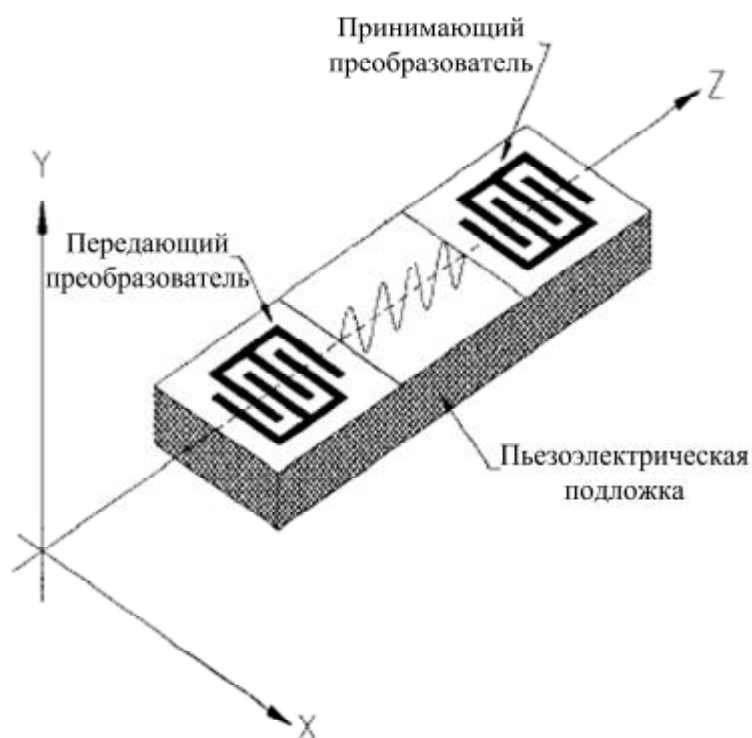
Рисунок 1.5 – Схема одинарной линии задержки
