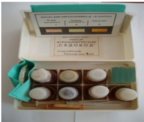
Рисунок 2. Внутреннее содержимое прибора для проведения тканевой диагностики минерального питания (ОП-2 «Садовод»)
