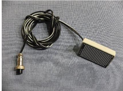
Датчик разлиния жидкости устанавливается на пол помещения в месте вероятных протечек воды охлаждения и/или готового продукта контактной поверхностью вниз.
