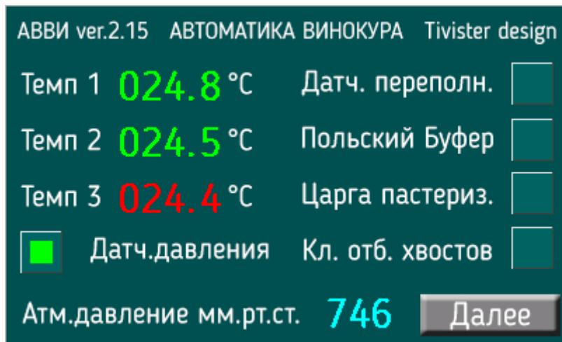
На левой стороне экрана отображаются показания датчиков температуры Темп1, Темп2 (основные) и Темп3 (аварийный на ТСА) и расположена кнопка-индикатор подключения к системе датчика давления в кубе.
