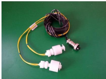
В версии 2.15 используются два датчика. Датчик является поплавковым нормально замкнутым. Срабатывание датчика (размыкание контакта) происходит при поднятии поплавка по вертикальному штоку.
