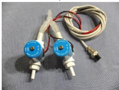
Клапаны отбора «голов» и отбора «тела» используются только в режиме ректификации. Внутри клапанов установлены жиклеры - прокладки из тонкого металла с калиброванным по диаметру отверстием для регулировки максимальной скорости отбора спирта.
