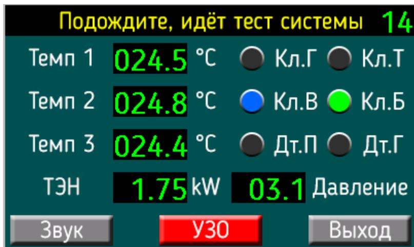
В левой части экрана расположены индикаторы датчиков температуры и мощности, подаваемой на ТЭН. Справа индикаторы включения клапана отбора голов (Кл.Г), отбора тела (Кл.Т), клапана подачи воды охлаждения (Кл.В), клапана ПБ/«хвостов» (Кл.Б), датчика переполнения приёмной ёмкости (Дт.П), датчика уровня голов (Дт.Г) и индикатор датчика кубового давления.
