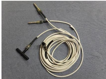
Датчик температуры **Темп1** используется при дистилляции на НБК и ректификации и устанавливается вверху системы, в штуцер колонны НБК или дефлегматора.
