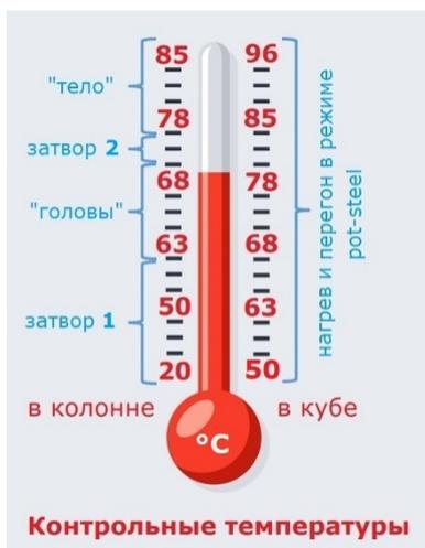
Закончив отбор тела, отключаем нагрев, открываем кран на сухопарнике и сливаем флегму, а кран оставляем открытым, чтобы выровнять давление в кубе с атмосферным, иначе при остывании бак может «схлопнуться» (деформироваться). Далее еще 1-3 мин. продолжаем охлаждение, затем отключаем и его. Разборку аппарата и открытие куба начинаем, спустя достаточное количество времени, когда стенки и остатки содержимого остынут до безопасной температуры.
