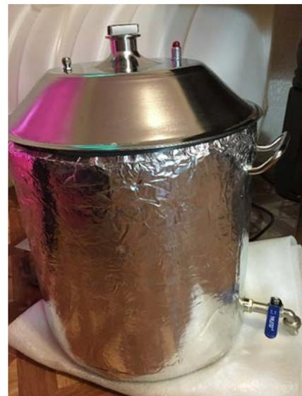
Для работы аппарата по схеме «дистиллятор – прямоточник» надежно соединяем куб с сухопарником и холодильником при помощи кламповых замков, не забывая ставить прокладки в каждый узел соединения. Первым закрываем куб, соединив его с крышкой штатным обручем через силиконовое уплотнение. Колонну на первой перегонке не ставим, в сухопарник ничего не загружаем. Сопротивление на пути к холодильнику должно быть минимальным, а путь у пара максимально коротким.
