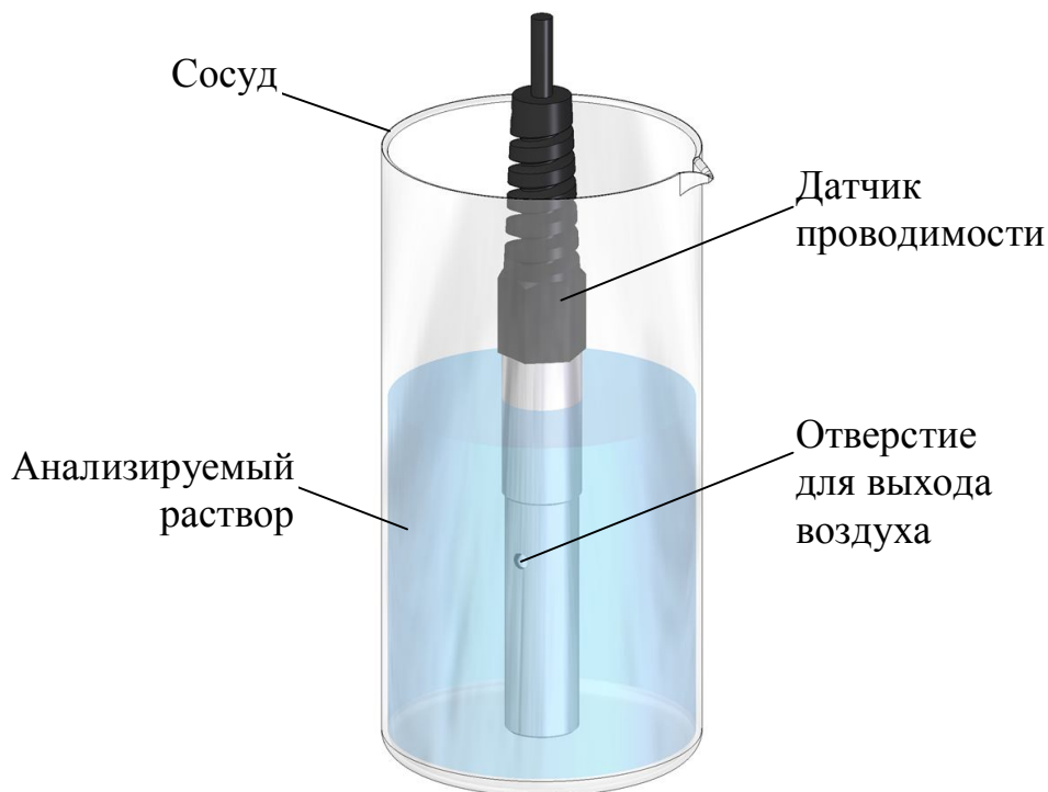
Рисунок 2.3 – Проведение измерений погружным методом
