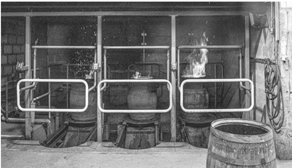
Рисунок 5. Обжиг бочек в Speyside Cooperage.
