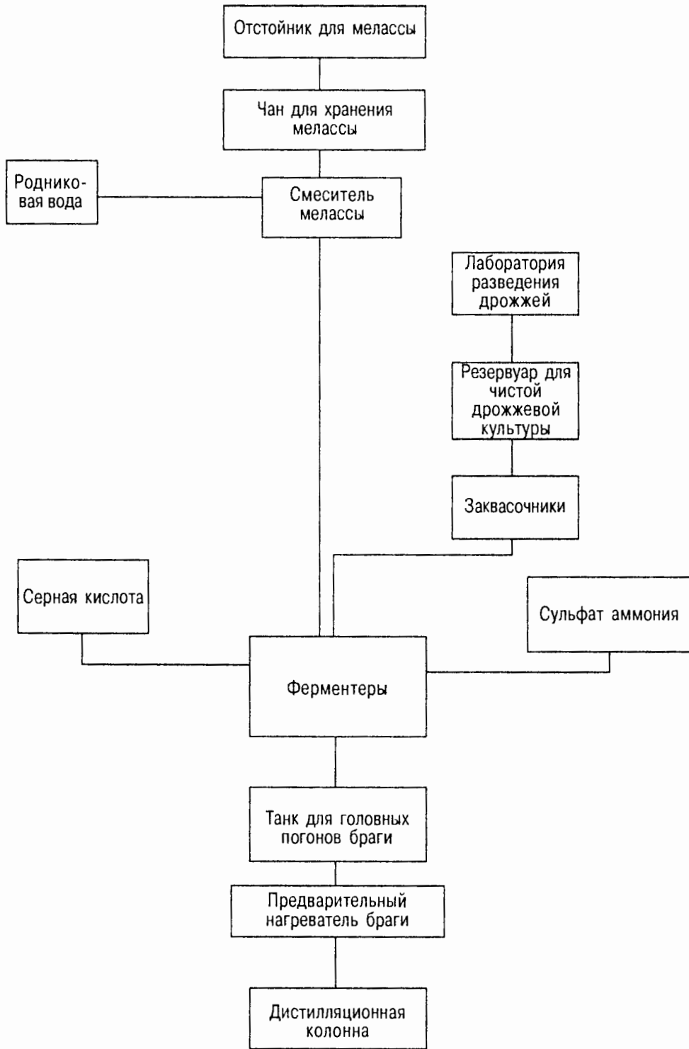
Рис. 12.6. Схема дистилляции в аппарате непрерывного действия
