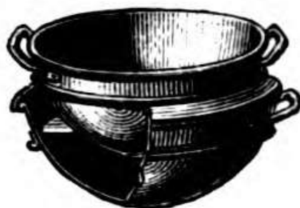
Двойной таз с круглым дном, на водяной бане (из красной меди).
