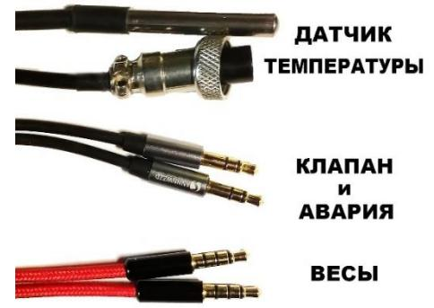
Подключать/отключать разъемы датчика температуры и весов при обесточенном блоке!
