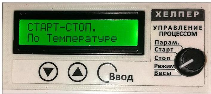
В положении переключателя «Режим» на дисплее в верхней строке указывается какой именно режим работы вы хотите выбрать - Старт-Стопный или Покапельный. В нижней строке приведен критерий по которому будет осуществляться остановка процесса перегона – по
