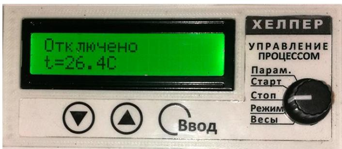
В положении переключателя «Стоп» можно **остановить** все запущенные до этого процессы, в том числе и циклический таймер или сделать **паузу** в ходе работы любого процесса с возвратом в исходное состояние.
