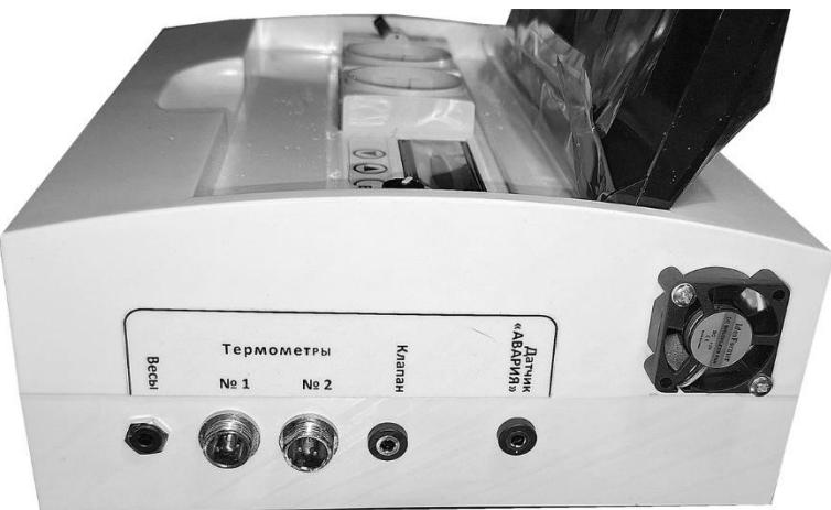
Вы всегда можете поменять датчики, сделав датчик №2 первым, а №1 вторым. Для этого в разделе «Параметры» на вкладке «Термометры» достаточно нажать кнопку «Поменять местами». Здесь же можно скорректировать показания температуры у датчиков используя эталонный термометр.
