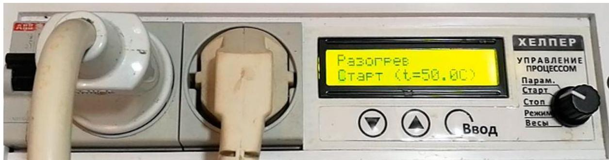
Запускаю разогрев куба в разделе "Старт", "Разогрев", предварительно установив нужную температуру 50 гр. в разделе "Параметры".
