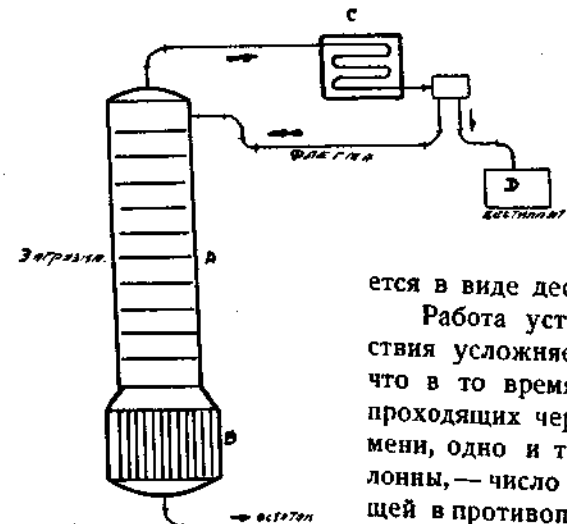
Фиг. 19. Схема непрерывно действующей колонны.
