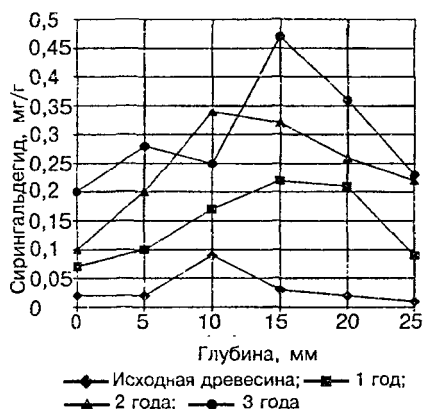
Рис. 21. Изменение содержания сирингальдегида в процессе сушки и выдержки древесины дуба
