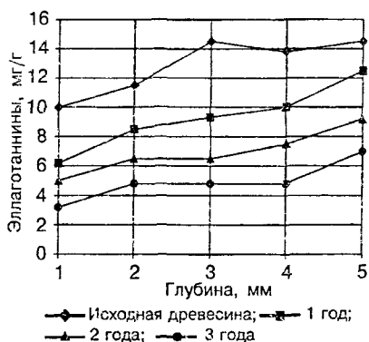
Рис. 17. Изменение общего содержания экстрагируемых эллаготаннинов в процессе сушки и выдержки древесины дуба
