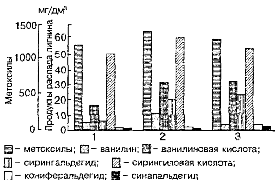
Рис. 24. Массовая концентрация метоксильных продуктов распада лигнина (1, 2, 3 — образцы дубового экстракта)
