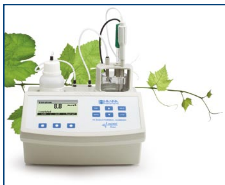
Рис. 5. Титратор для определения ассимилируемого азота HI 84433-02 (Hanna Instrument)
